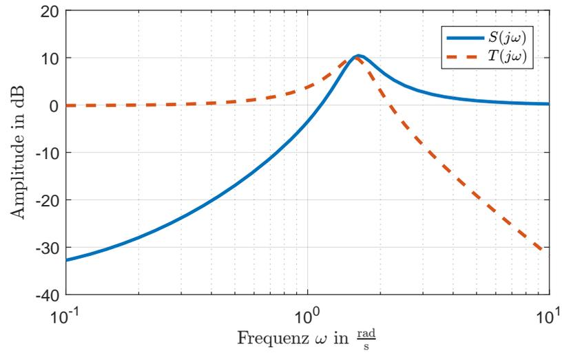
Abbildung 1: Amplituden von  $S(j\omega)$  und  $T(j\omega)$
